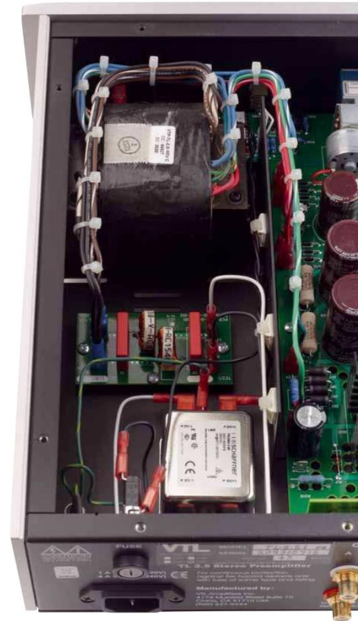
*Das Netzteil bezieht gleich doppelt gefilterten Strom aus der Steckdose*
