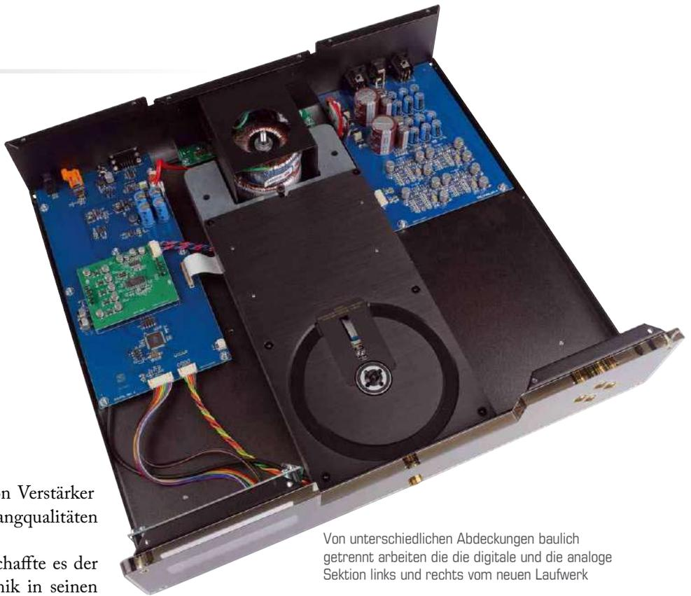
Von unterschiedlichen Abdeckungen baulich getrennt arbeiten die digitale und die analoge Sektion links und rechts vom neuen Laufwerk
