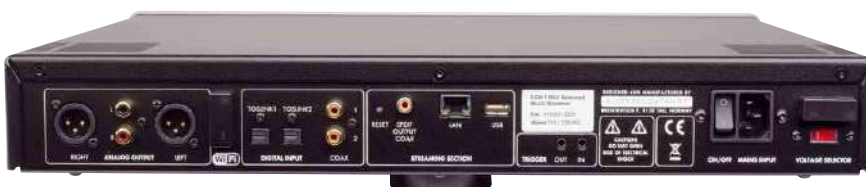
Dank einer Auswahl unterschiedlicher Anschlüsse ist der ECM1 auch als DAC für externe Quellen gut aufgestellt
