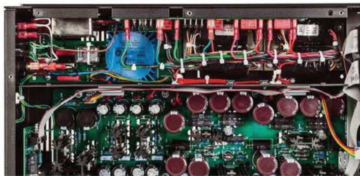
Oben: der ordentlich Wärme produzierende Shunt-Regler. Unten: Das vom schirmenden Gitter befreite Netzteil
