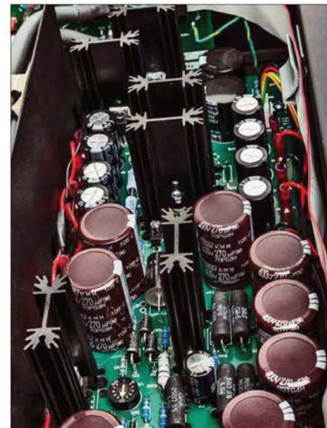
Oben: der ordentlich Wärme produzierende Shunt-Regler. Unten: Das vom schirmenden Gitter befreite Netzteil
